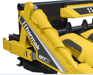
KONİK YAN HELEZONLAR CONICAL SIDE AUGERS
