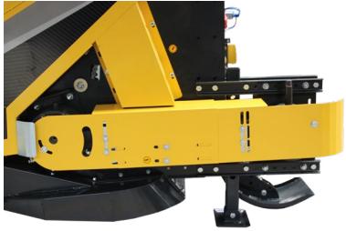
YAN ŞANZIMANLAR SIDE TRANSMISSIONS
