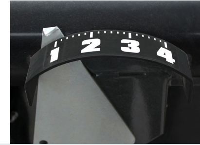
SAP GENİŞLİĞİ AYARI GÖSTERGESİ STEM WIDTH ADJUSTMENT INDICATOR
