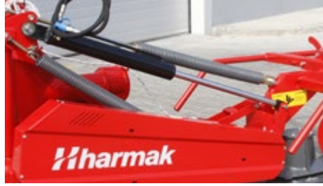
GÜÇLÜ PİSTON VE YAY SİSTEMİ STRONG PISTON AND SPRING SYSTEM
