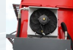
YAĞ SOĞUTMA SİSTEMİ
